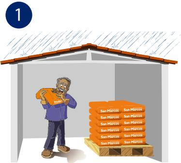
1 Almacenar el cemento en lugares cubiertos y secos, protegidos de la lluvia y de las corrientes de viento.
