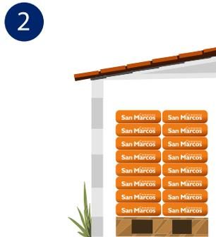
2 Colocar el cemento sobre estibas de madera o plásticas, de tal forma que el cemento no quede en contacto con el piso. También debe quedar separado de los muros.
