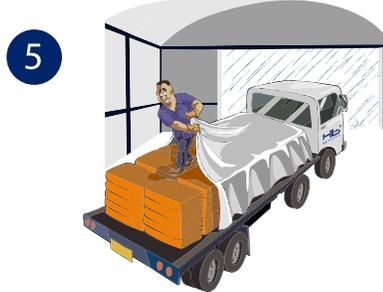
5 Al transportar el cemento se debe cubrir con plásticos, lonas o materiales impermeables, igualmente debe protegerse la plataforma del vehículo sobre la cual se coloca el cemento. No descargar cuando esté lloviendo, o protegerlo adecuadamente. Todo saco que se humedezca debe ser consumido inmediatamente.
